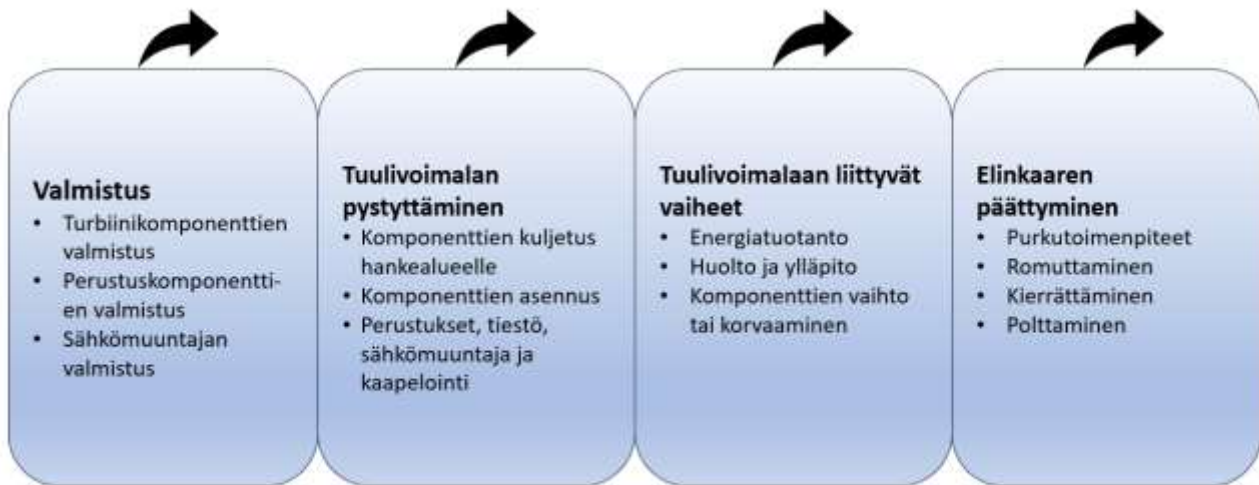
Kuva 29. Hankkeen kasvihuonekaasupäästöt arvioidaan koko elinkaaren aikana. Elinkaari on jaettu neljään moduuliin (Muokattu lähteestä Vestas V162-6.2 MW EPD, 2023)
